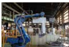
注湯ロボット
