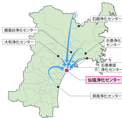
図6 下水汚泥の集約資源化イメージ
