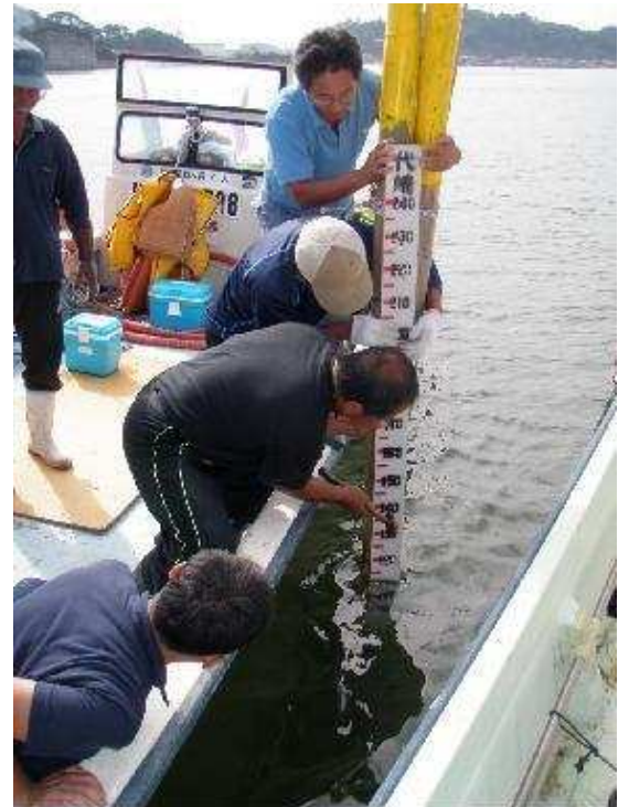
水深棒設置作業
