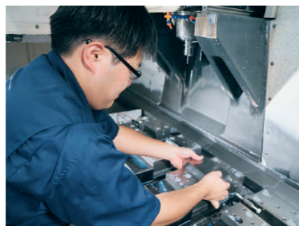
半導体関連の製品をセットする工程。すべての製品を並行に、同じ圧力ではめ込む精密さが求められる。
