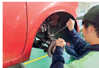
緩衝装置分解組み立て実習の様子。より実践に近い作業を、実技訓練を通して学び、技術を習得する。
