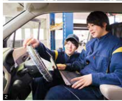
①自動車の点検整備について学ぶ自動車整備科の訓練生 ②外部診断機を使って自動車の故障診断を行う訓練生
