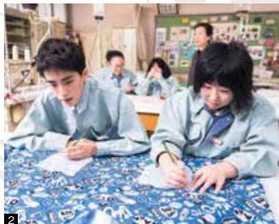
①工業用ミシンを操作して縫製作業について学ぶ総合実務科手工芸コースの訓練生 ②ポケットを縫い付けた部分の柄がずれないように、生地を裁断する前に行う「柄合わせ」の作業
