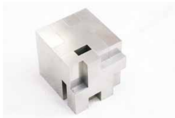
新人研修の実習課題として考案されたキューブ。6つの面を構成するパーツはそれぞれ形が異なり、パズルのように組み合わせると、1つの立方体が完成する
