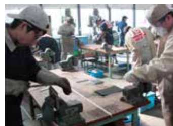
競技材に丁寧にやすり掛けをし、開先の加工を行う参加者
