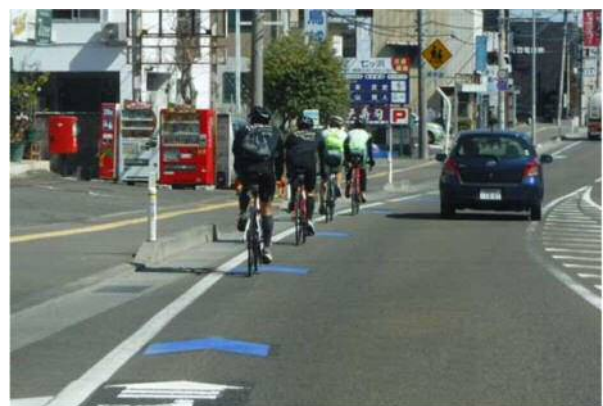
▲ 矢羽根型路面表示設置の状況 〔(国)45号（七ヶ浜町）〕
