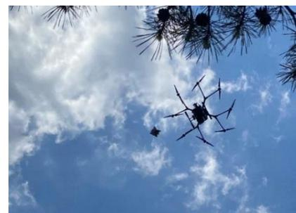
（ドローンによる投下試験の状況）
