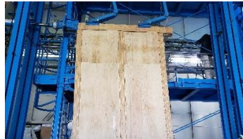
超厚合板耐力壁試験
