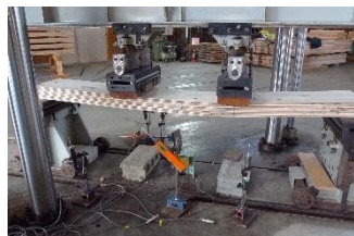
高剛性床材モデルの 強度性能試験
