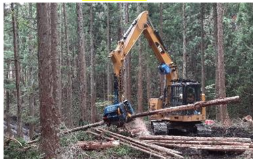
高性能林業機械を用いた間伐材生産
