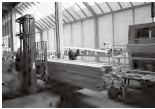
県産スギラミナの強度測定
