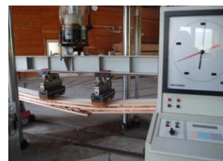
CLTの強度性能確認
