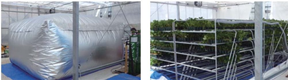
図3-20 すくすくバッグシステム(日本液炭(株)製)による二酸化炭素くん蒸装置内部の状況
