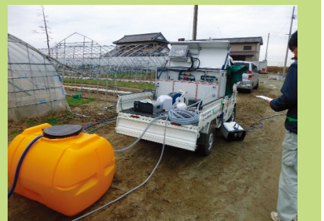
図16 電気自動車と可搬型農業用逆浸透膜装置
