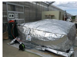
(株)アグリクリニック研究所製の炭酸ガスくん蒸処理装置の内部(上図)と外観(下図)
