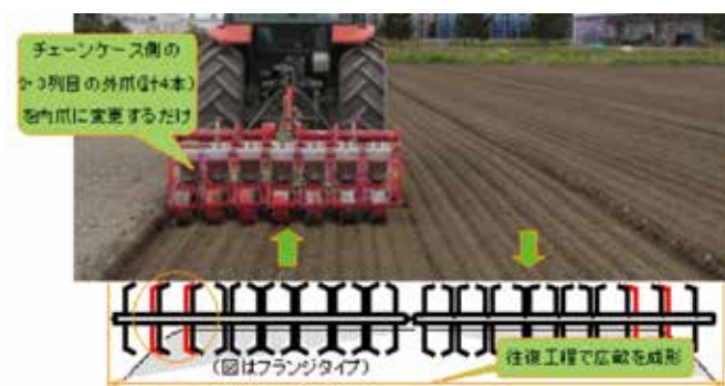
図16 逆転ロータリの爪配列変更で広畝を成形(図中の播種機は2m幅)
