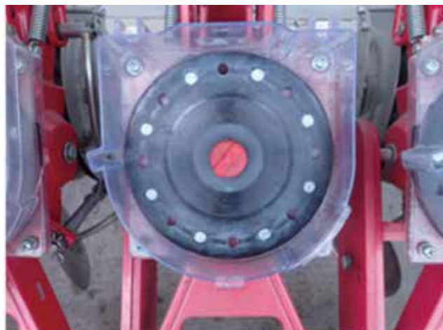
図15 乾直水稻の播種量(表4)に合わせてパテで塞ぎ8穴にした状態
