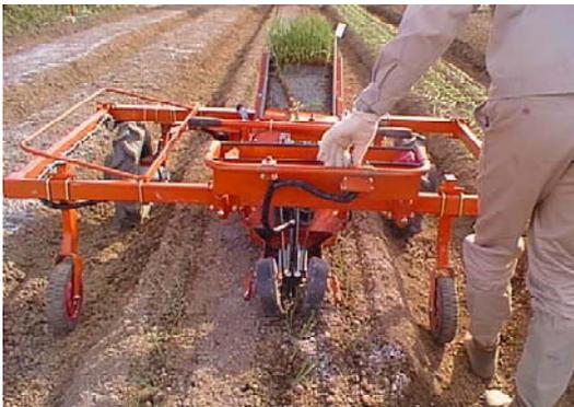
図1 自走式バイピッチ移植機
