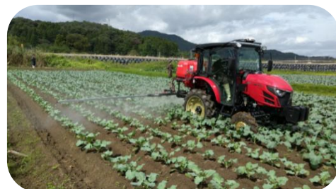
RTK基地局を活用した自動操舵機械の実演
