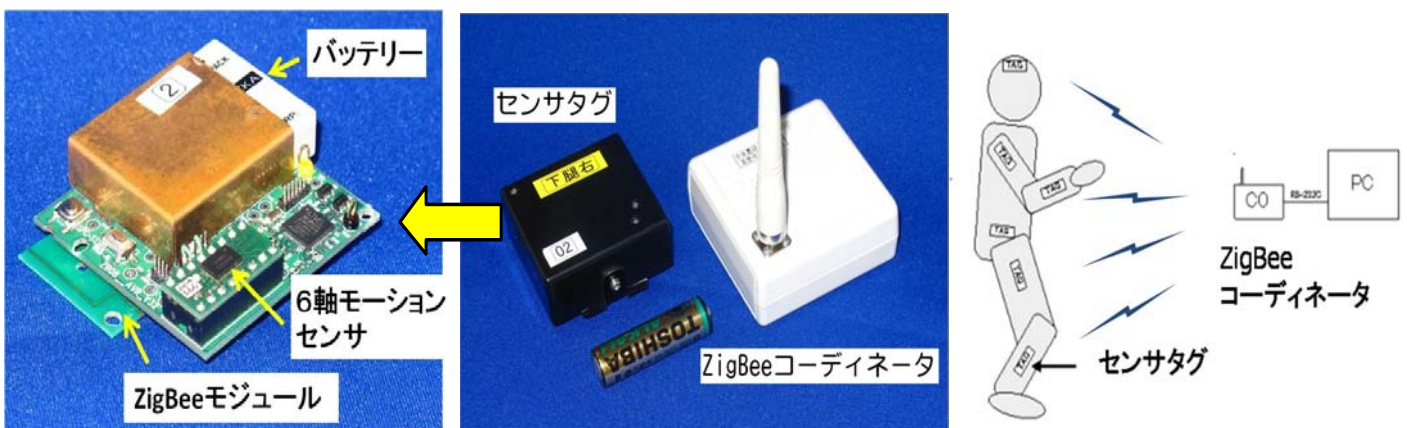
センサタグの取付け (上腕・前腕・上腿・下腿の 左右 8 箇所、背中 2 箇所)
