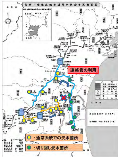
図 11 平成 20 年岩沼市南長谷地区内で発生した漏水での対応例
