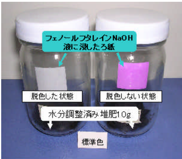
写真1 CO 2 放出速度簡易測定の様子
