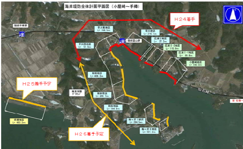
①松島町農地海岸堤防全体計画平面図（小屋崎～手樽），②今回着手箇所標準断面図及び③完成イメージ図
