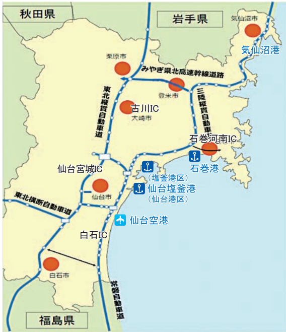
図1 宮城県内の高規格幹線道路・地域高規格道路指定路線図
