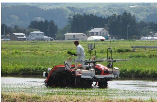
測位衛星を使った高精度測位(D-GNSS)により、直進時に自動運転アシストする田植機が「直進アシスト田植機」です。この機能を装備した田植機での移植
