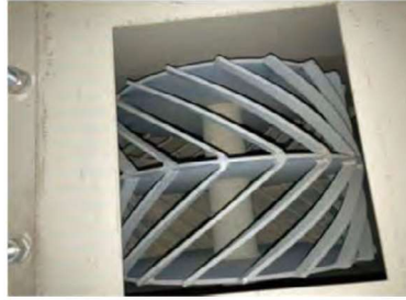
①昇降機 下部ブーツ内カゴ型内車 ブーツ上部の点検口を 開けて清掃
