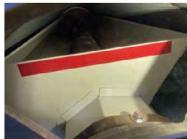
⑥精選機 シリンダー内部 アクリル窓を開けて清掃
