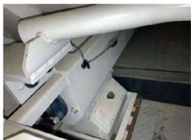
⑥精選機 内部排出スクリー底 下部カバーを開けて清掃 レバーにてカバー開閉
