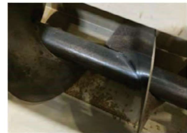
⑥精選機 排出スクリー底 上部カバーを開けて清掃
