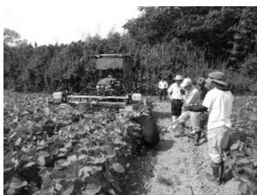
○摘芯機の高さ等調整作業
