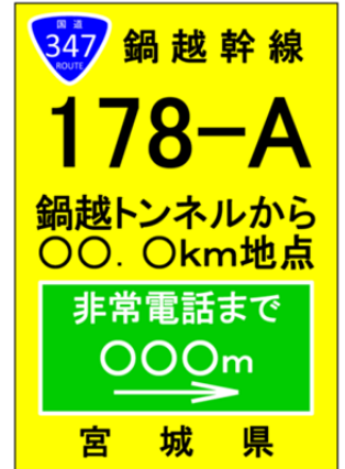
電力柱番号表示の例
