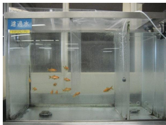
バイオアッセイ（魚類飼育槽）による行動異常の感知状況（原水・ろ過水）
