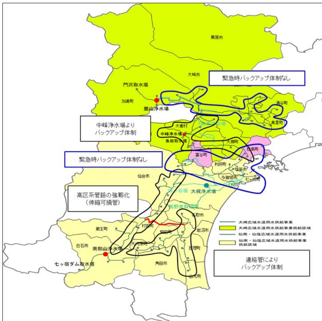
送水管のバックアップ体制の現状
