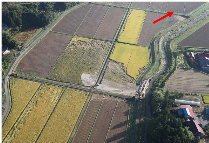
空撮(復旧状況及び溢水痕跡)
