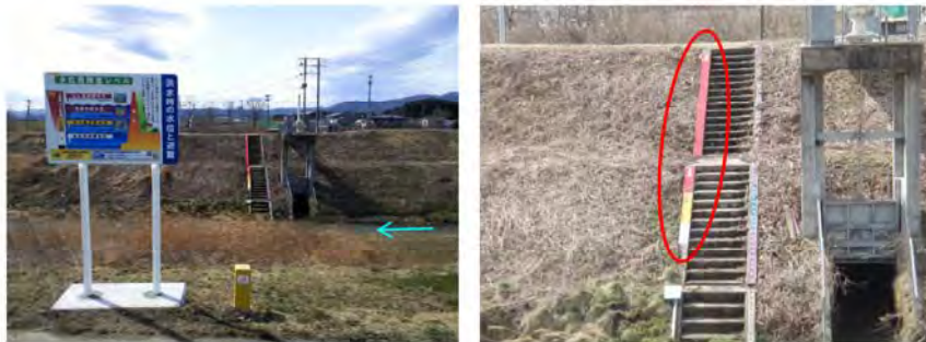
図 2-41 水位レベル表示板（小田川）
