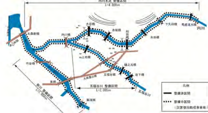
図 1-19 河川工事の進捗状況
