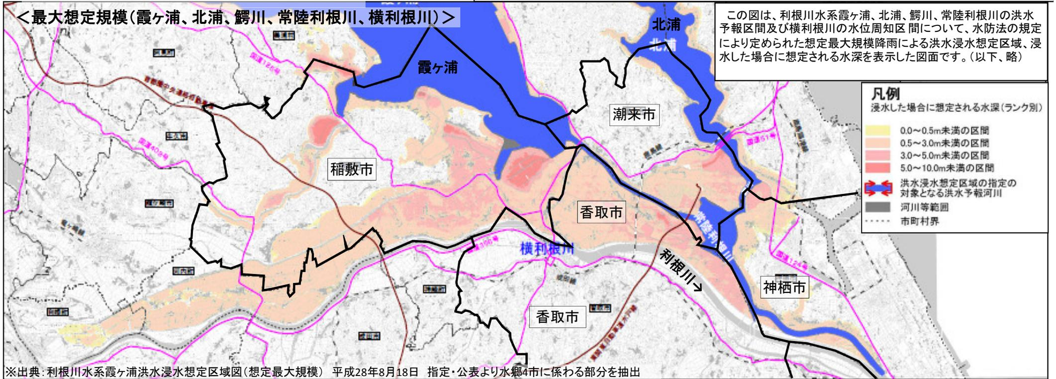
この図は、利根川水系霞ヶ浦、北浦、鰐川、常陸利根川の洪水予報区間及び横利根川の水位周知区間について、水防法の規定により定められた想定最大規模降雨による洪水浸水想定区域、浸水した場合に想定される水深を表示した図面です。(以下、略)
