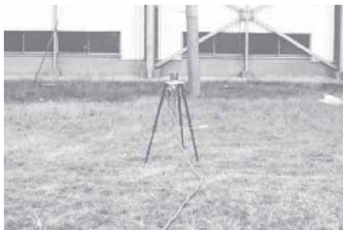
図 4 検出器を三脚に設置（検出器中心高さ地上 1 m）
