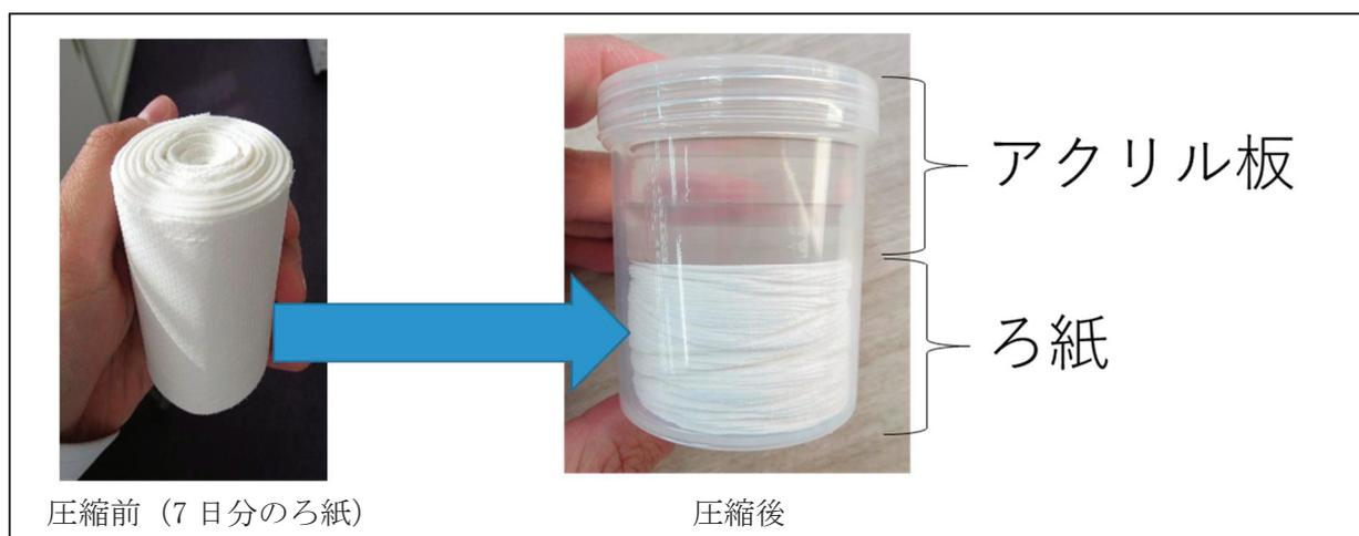
図 10 長尺ろ紙の圧縮前と、圧縮し U8 容器に入れた後の様子
