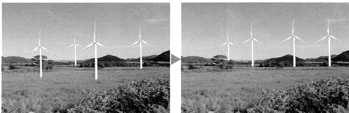
写真13 眺望の支配線(植生界)に沿った風力発電施設の配置による効果のシミュレーション
