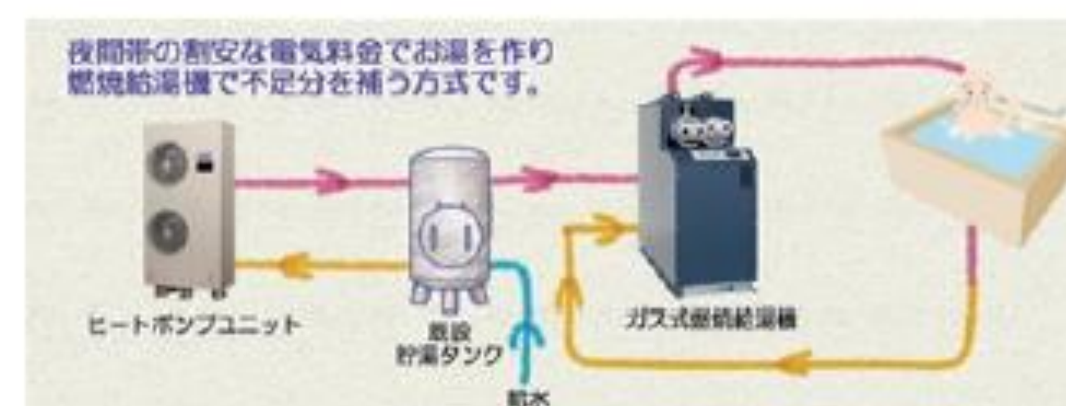
▲導入ボイラーシステム系統図
