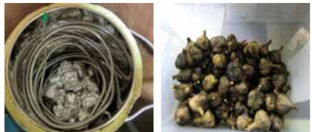
▲新型熱交換器で加温した温水を導入した恒温チャンバー内で試験製造した黒ニンニク
