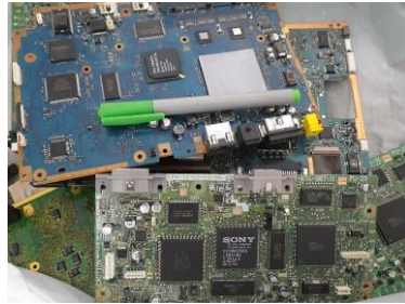
高品位の基板 (ゲーム機より回収)
