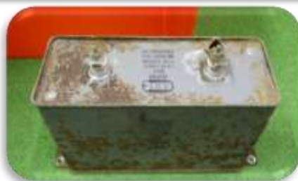
溶接機内のコンデンサー
