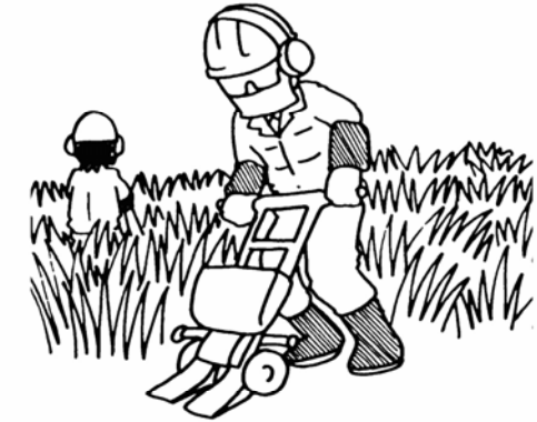
②異物を除去するため、飛び石防止装置を取付けた機械で作業しているか ③他の作業員と接触しないようにしているか
