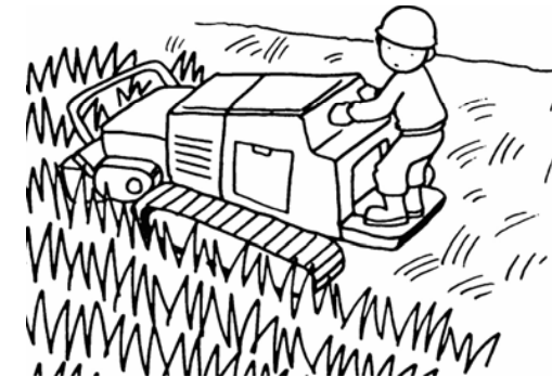
①異物を除去するため、飛び石防止装置を付けた機械で作業しているか 事前に地形を確認しているか 作業機械の転倒防止措置を講じているか
