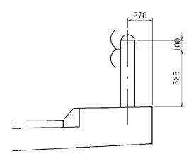
図2-43 中央分離帯側ガードレールの設置位置
