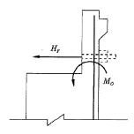
$H_F$  : 落橋防止構造の設計に用いる地震
