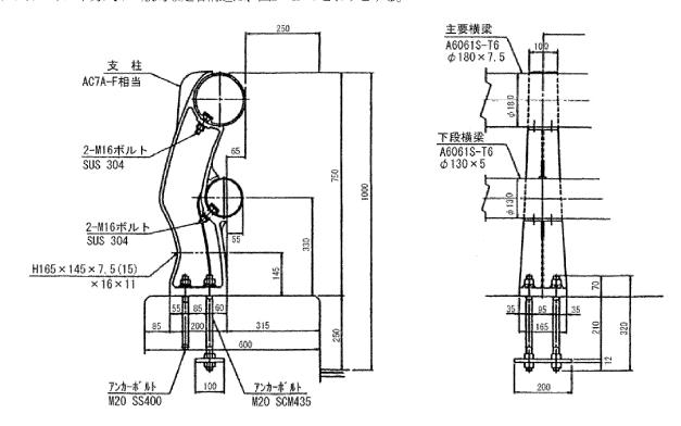
図2-45 アンカーボルト方式の定着構造
