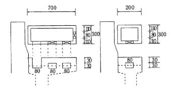
図2-57 排水ますの加工例
