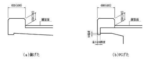
図2-46 車両用防護柵部の地覆形状
