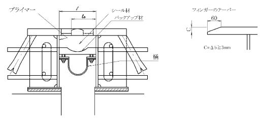
図2-75 鋼フィンガージョイント(非排水構造)
