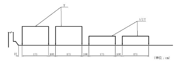
図2-2 主げた設計時のT荷重の載荷方法
