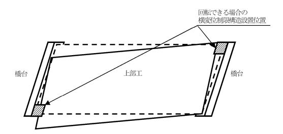
図 231 上部工構造が回転できる場合の横変位制限構造設置位置
