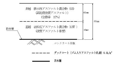
図2-55 高機能舗装の場合の舗装構成
