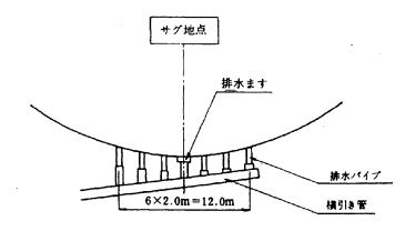
図2-61 サグ地点の排水ますと排水パイプの配置例
