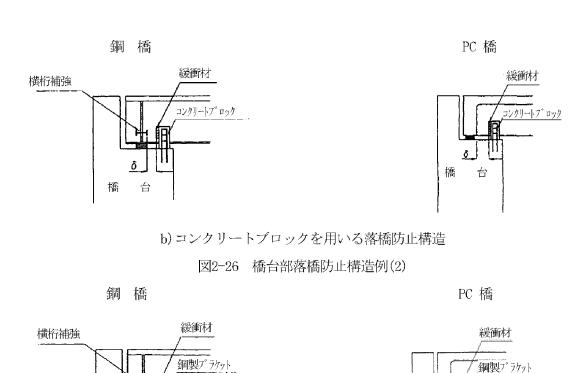
c) 鋼製ブラケットを用いる落橋防止構造 図2-27 橋台部落橋防止構造例(3)
