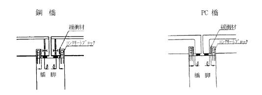
c) コンクリートブロックを用いる落橋防止構造 図2-29 橋脚部落橋防止構造例(2)
