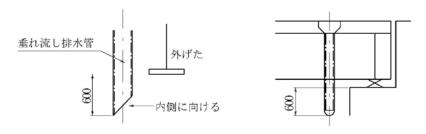
図2-63 垂れ流し排水管の下端処理
