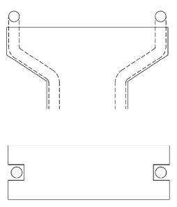
図 2-67 下部工軀体の配管例
