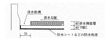
図2-56 縦断方向の排水処理例
