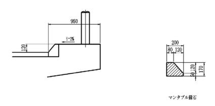
図 2-47 高規格幹線道路の地覆形状
