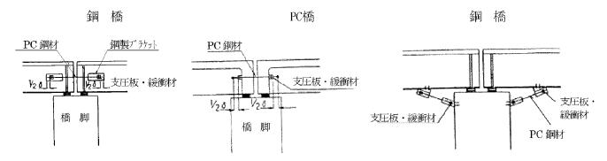
a)2連の上部構造を相互に連結する落橋防止構造 b)橋脚と上部構造を連結する落橋防止構造 図2-28 橋脚部落橋防止構造例(1)
