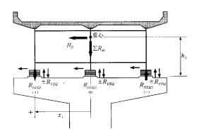
図 2-12 地震力によって生じる支承部反力
