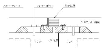
図2-73 大変位吸収システムの構造(両側可動式)
