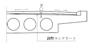
図2-51 PC箱げた、PCおよびPCC末版構造の床版の折れ位置(2)
