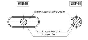
図 2-18 支承下面の標準構造
