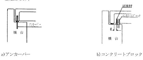
図 2-33. PC 橋の横変位拘束構造例
