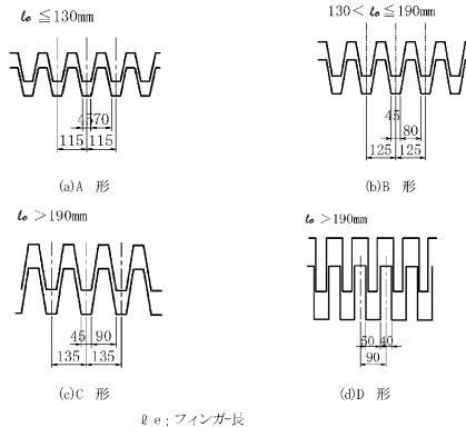
ℓ e: ノインカー反図2-78 フィンガー長によるフィンガーの形状
