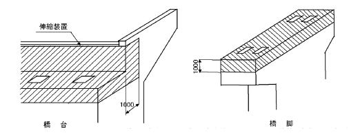
(施工順字などにより施工可能な範囲にコンクリート塗装を施すものとする。)
