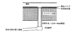
(b) 床版の水抜き孔 (排水パイプ)
