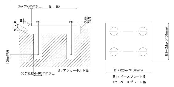
図2-15 支承下面の標準構造寸法
