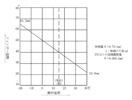
図2-79 遊問〜据付温度図(鋼橋、L=60mの場合)
