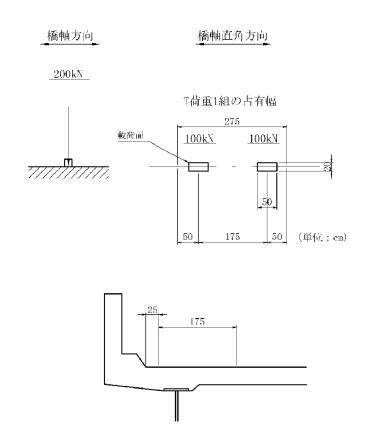
図2-1 T荷重の載荷位置
