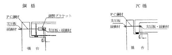
a)橋台と上部構造を連結する落橋防止構造 図2-25 橋台部落橋防止構造例(1)
