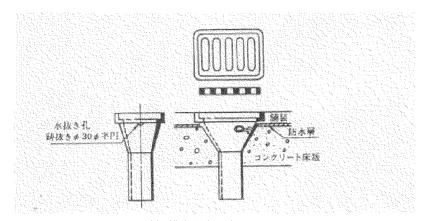
(a) 排水ますの水抜き孔
