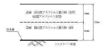
図2-54 通常舗装の場合の舗装構成
