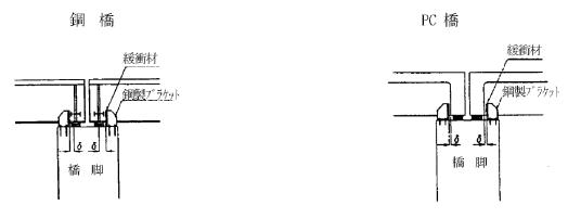
d) 鋼製ブラケットを用いる落橋防止構造 図2-30 橋脚部落橋防止構造例(3)
