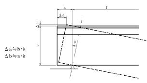
図2-74 橋端部の回転変位
