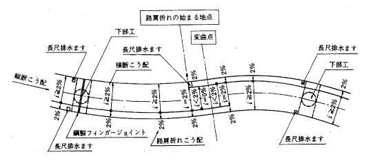
図2-62 変曲点付近の排水処理
