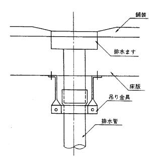
図2-70 排水ますと排水管の接続部
