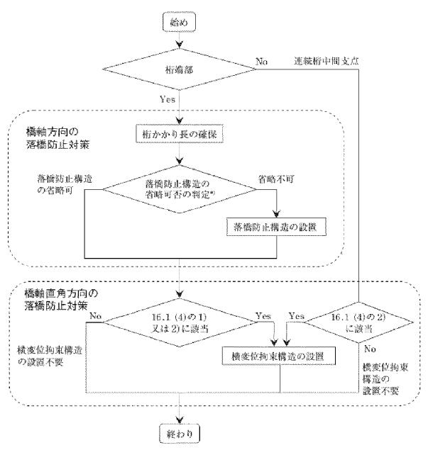
"橋軸方向の落橋防止構造の省略の可否については、橋軸方向に大きな変位が生じにくい構造特性を有する橋又は端支点の鉛直支持が失われても上部 構造が落下しない構造特性を有する橋という観点から判定
