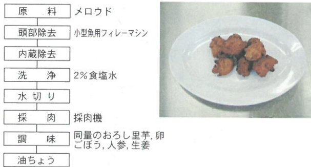
図11 変わり揚げ製造工程および写真
