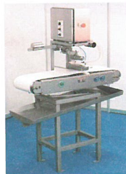
図1 ピンボーン除去機（カイオルセン）
