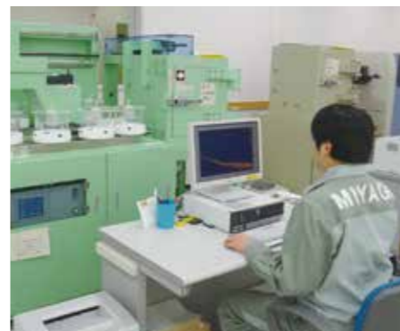
ゲルマニウム半導体検出器 各試料に含まれるセシウム137等の濃度を測定
