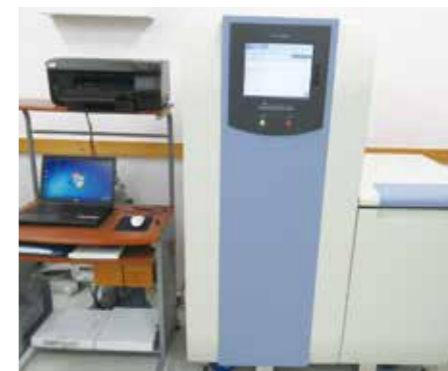
液体シンチレーションカウンター 水道原水や海水に含まれるトリチウムの濃度を測定
