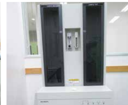
ベータ線測定装置 牡蠣やワカメ等に含まれるストロンチウム90の濃度を測定
